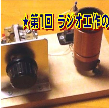
★第1回 ラジオ工作の原点! ボビンにコイルを巻いてゲルマラジオを作るう!
